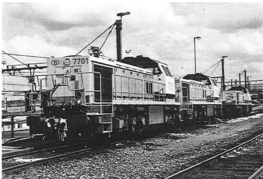
Reeks 77 werd onmiddellijk ingezet voor het verwerken van de rangeeringen in het station Antwerpen-Noord. We zien hier de locomotieven 7701, 7726 en 7705 op de rangeerheuvel van bundel C, kort nadat ze in treinschakeling toekwamen. Bemerkt de horizontale stand van de BSI-koppeling en het voeren van de rood-witte koplichten, wat erop duidt dat deze locomotief gebruikt wordt als opdrukmachine naar de rangeerheuvel toe. Foto : Jan Mahieu, Antwerpen-Noord, 29 april 2001.
